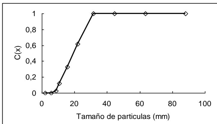
Figura 4. Función clasificación para la trituradora de cono.
