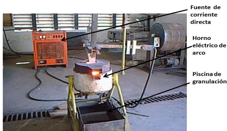
Figura 1. Equipamiento utilizado para la obtención carbotérmica de las ferroaleaciones al Cr-Mn.
