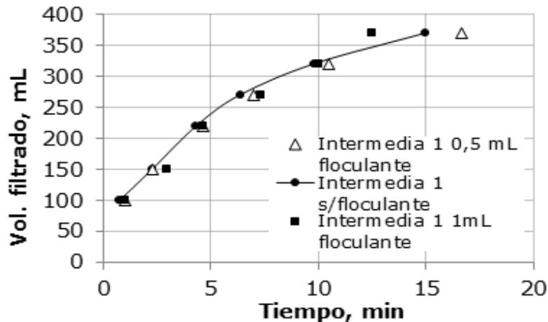
Figura 5. Volúmenes de filtrado con agregado de floculante y sin este.
