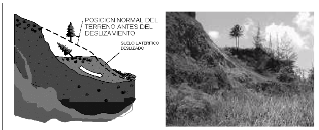
FIGURA 5. Deslizamientos a través de una superficie circular en cortezas lateríticas compuestas por suelos cohesivos- friccionantes.
