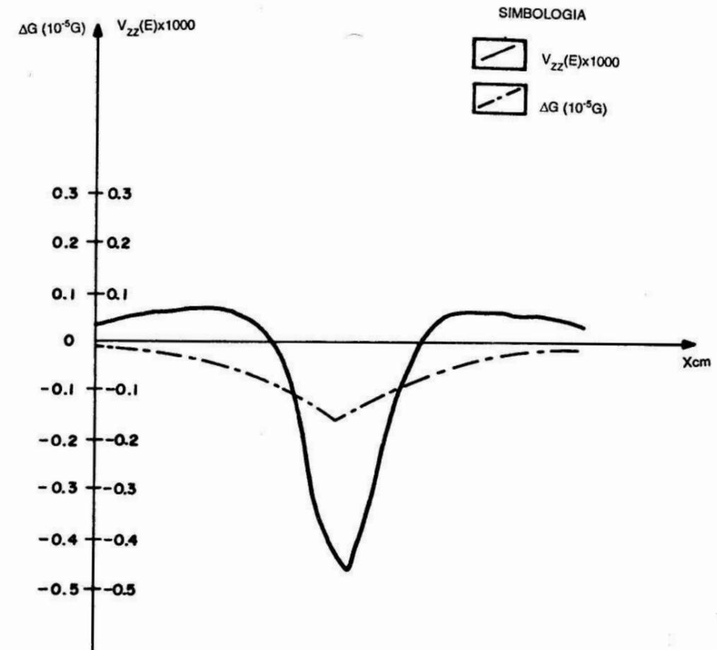
FIGURA 2. Gráfico de  $V_{zz}$  y  $\Delta G$  sobre una estructura artificial (túnel) comprobado posteriormente.
