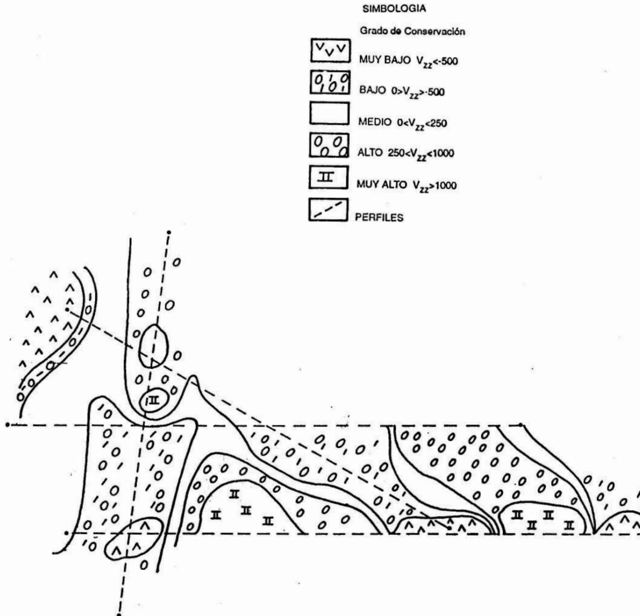
FIGURA 1. Distribución del grado de alteración de la roca en función de los valores de  $V_{zz}$  medidos.
