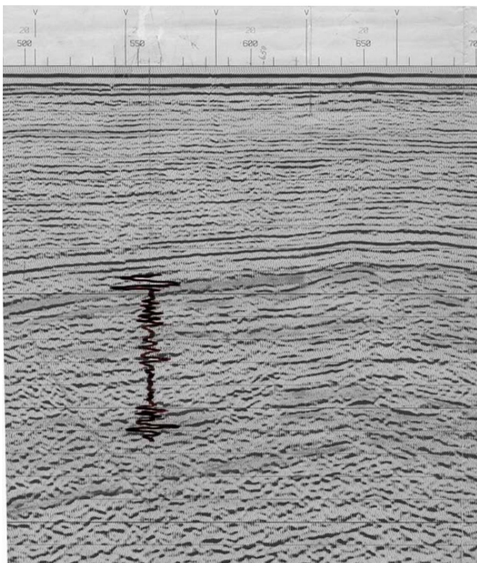
Figura 6. Corte sísmico A en el que se ve la traza sintética ubicada en la posición de un pozo profundo.
