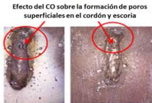
Figura 3. Cordón de soldadura obtenido con el electrodo fabricado, con escoria (izquierda) y sin esta (derecha).
