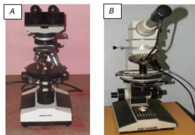
Figura 2. A-Microscopio petrográfico de luz polarizada modelo NP-400B, marca NOVEL. B-microscopio petrográfico de luz polarizada JENALAB POL de la CARLZEISS JENA con la videocámara digital ocular MDCE-5A con cable USB 2.0 insertado.
