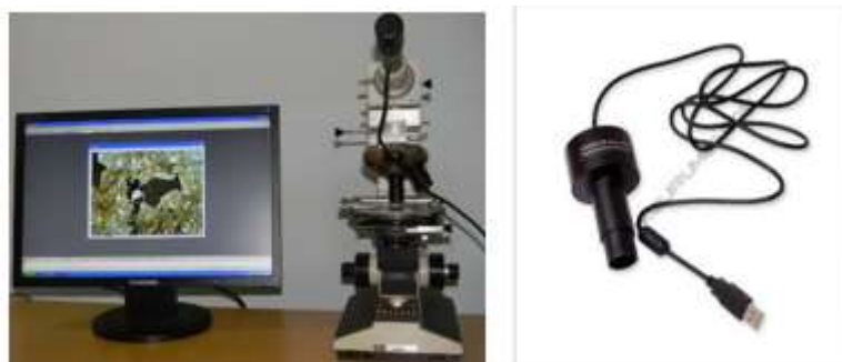
Figura 3. Computadora con el microscopio petrográfico de luz polarizada Jenalab Pol y la videocámara digital ocular MDCE-5A insertada.
