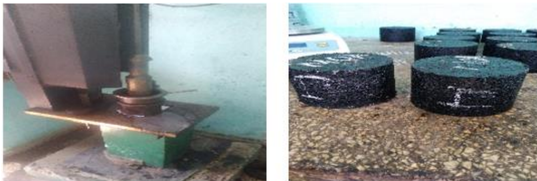
Figura 6. Equipo utilizado para la compactación de las probetas, a la izquierda. A la derecha se observan las probetas resultantes.
