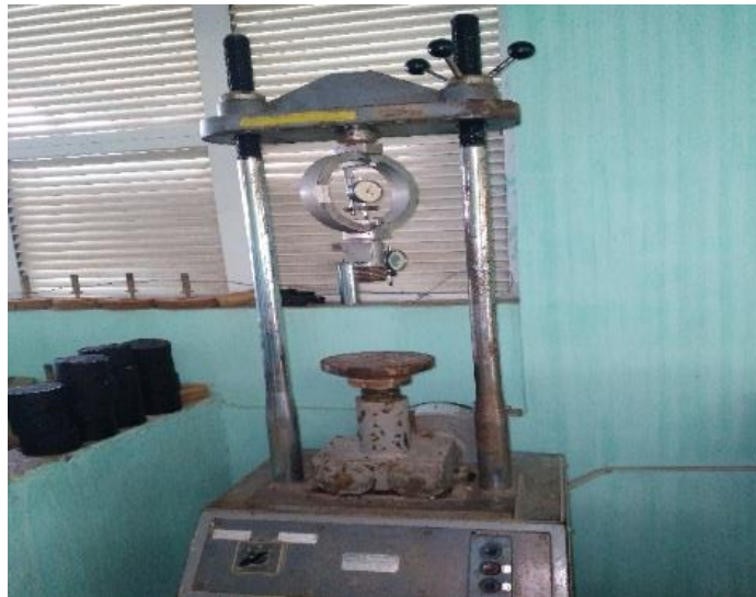
Figura 7. Prensa Marshall para la determinación de la estabilidad y la deformación de las probetas.
