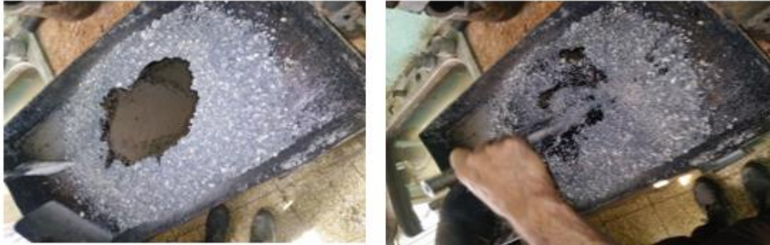
Figura 5. A la izquierda, colocación del lodo petrolizado dentro de los áridos. A la derecha, proceso manual de mezclado de los áridos con el lodo petrolizado.
