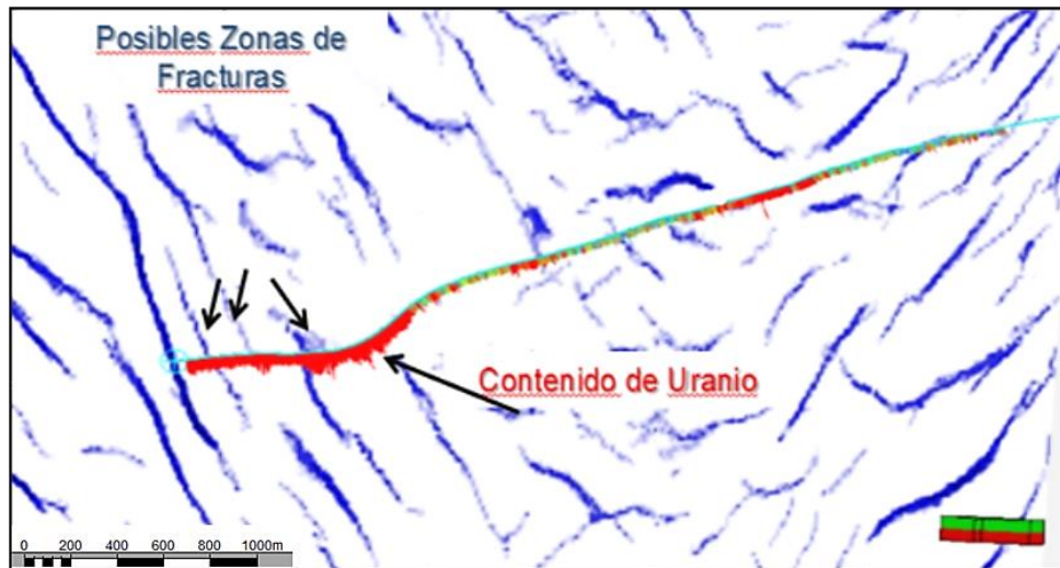
Figura 3. Línea Arbitraria: Ant Tracking sobre la trayectoria de un pozo, donde se destacan en azul las posibles zonas de fracturas, y sobre la trayectoria del pozo, según el registro geofísico, el contenido de uranio en rojo.
