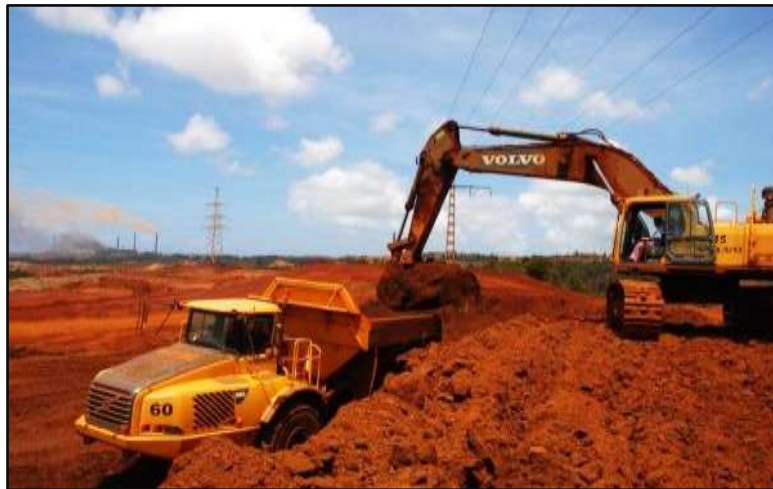
Figura 3. Sistema de extracción y transporte del mineral laterítico. Fuente: Fonseca-Aguilar (2024).
