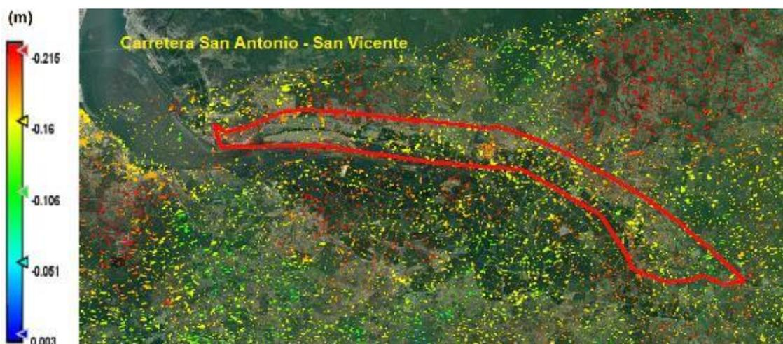
Figura 14. Resultados de los desplazamientos para el periodo 2017-2019.
