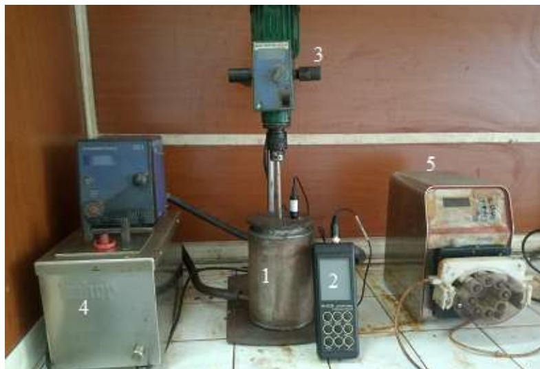
Figura 2. Instalación experimental para la lixiviación a presión atmosférica con ácido sulfúrico.
