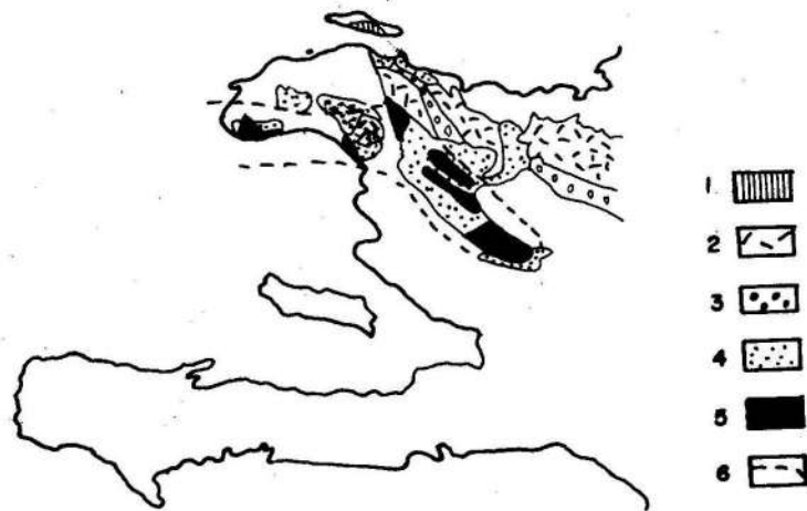
Fig. 6. Areas de afloramiento de las rocas premiocénicas del norte y centro de Haití. 1- metamorfitas (mármoles); 2- vulcanitas cretácicas; 3- Fm. Trois Rivières; 4- rocas calcáreas del Paleógeno Inferior y Medio; 5- vulcanitas paleógenicas; 6- límite probable de la cuenca volcánica eocénica.
