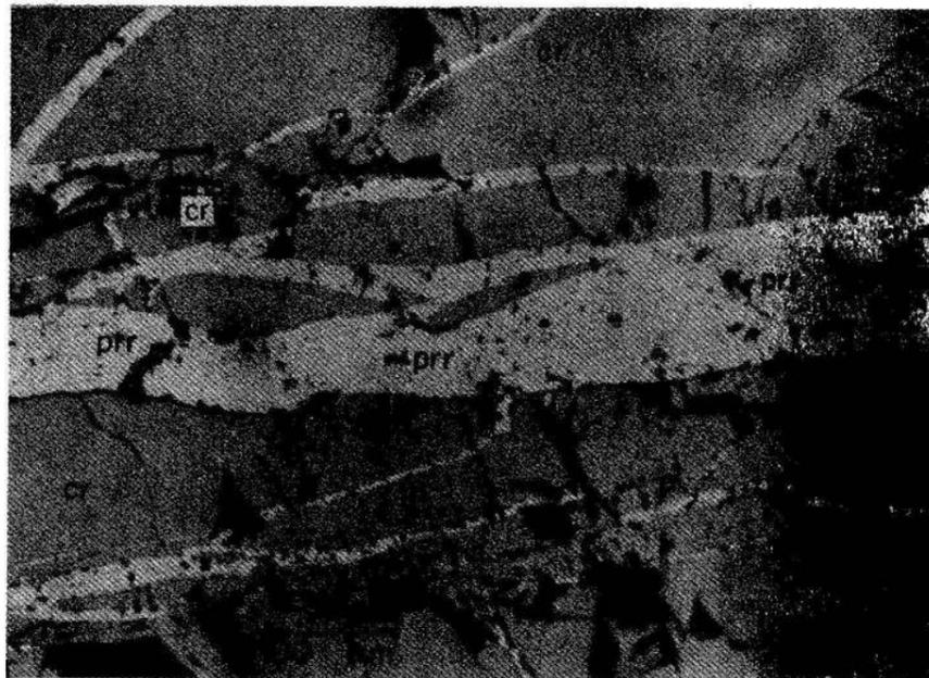
F. Microfotografía. Muestra PS-6-a. Pirrotina (pr) relleno de microgrietas en las espinelas cromíferas (cr). Luz reflejada, en aire, sin nicoles cruzados (JENAPOL-U).
