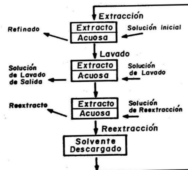
FIGURA 1. Diagrama de flujo de extracción por solventes.
