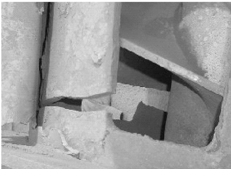
Figura 8. Tubo fracturado (cortesía Empresa Che Guevara-Moa).
