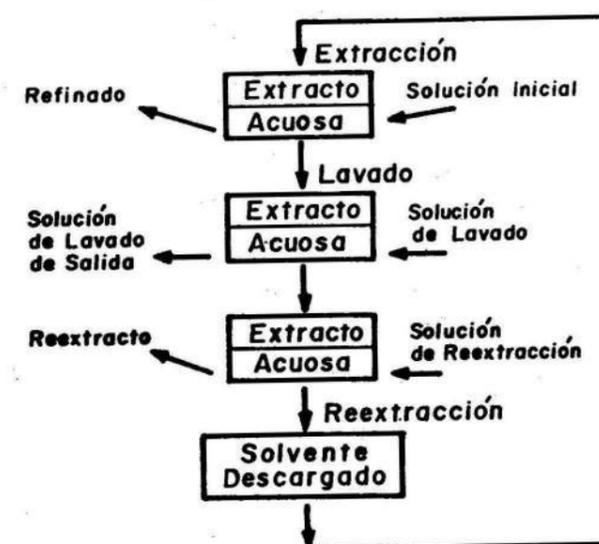
FIGURA 1. Diagrama de flujo de extracción por solventes.
