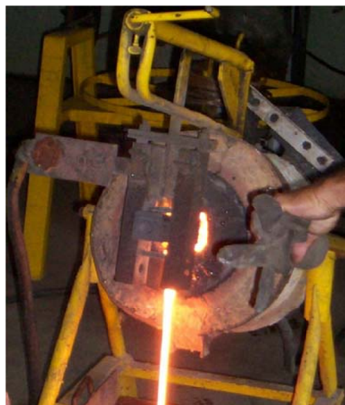
Figura 2. Horno de arco eléctrico vertiendo el fundente fundido.
