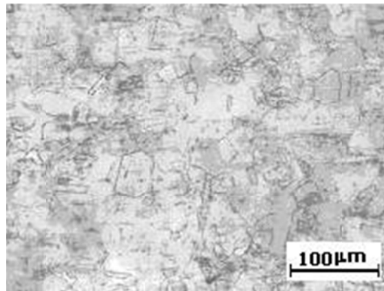
Figura.1. Micrografía del acero AISI 316. Reactivo ácido oxálico al 10 %.
