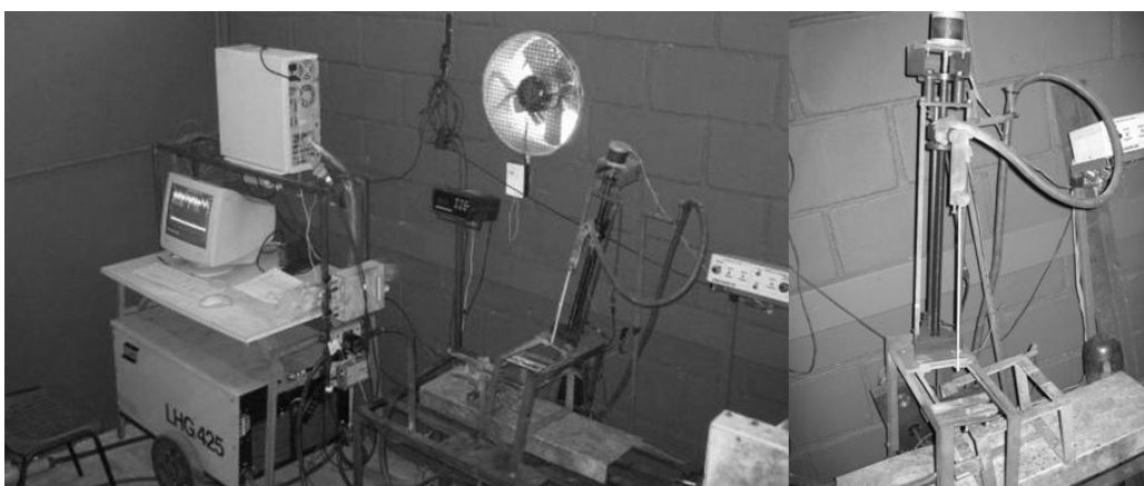
Figura 2. Instalación experimental para la soldadura mecanizada con electrodo revestido.
