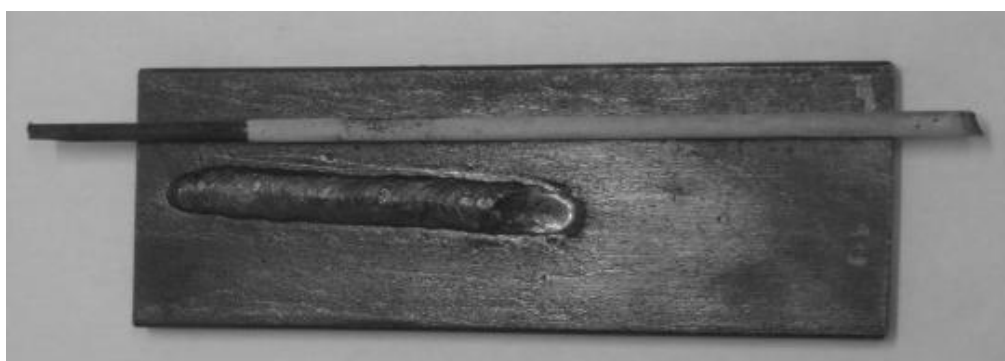
Figura 3. Depósito terminado y colilla del aporte (proceso por arco).
