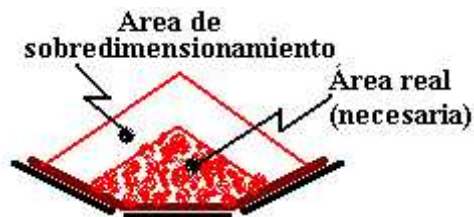
Figura 2. Área de sobredimensionamiento del diseño del transportador CO2CO3 de la ECRRL.
