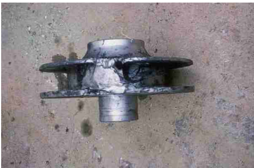
Figura 1. Impelente de la bomba centrífuga GRT/160/71 dañado por los efectos de la cavitación.
