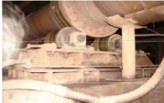
Figura 1. Imagen del transportador donde se observan los rodillos junto a la llanta.
