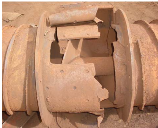
Figura 1. Tubo averiado (cortesía Empresa Ernesto Che Guevara. Moa)
