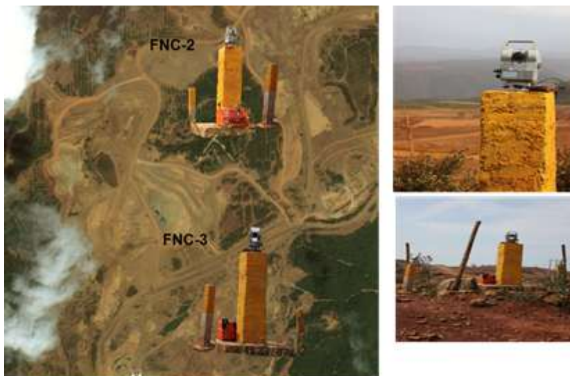
Figura 4. Mediciones recíprocas entre los puntos FNC-3 y FNC-2.
