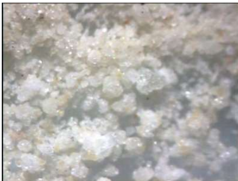
Figura 7. Microfotografía para la muestra M-4 del mineral melanterita depositado a la salida del socavón.
