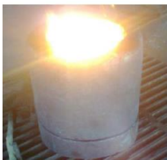
Figura 1. Reactor de grafito durante el procesamiento aluminotérmico.
