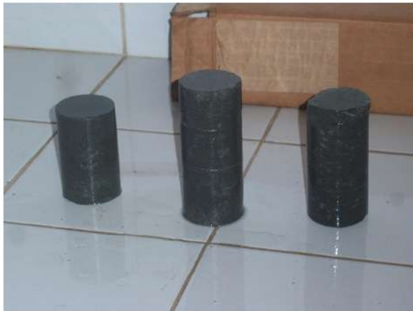
Figura 6. Testigos cilíndricos de la roca argilita utilizados en los ensayos para determinar la resistencia a tracción y compresión.
