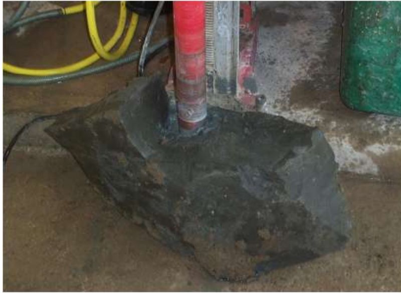
Figura 5. Monolito de la roca argilita extraído del frente del túnel de Buenaventura para preparar los testigos para los ensayos de tracción y compresión.
