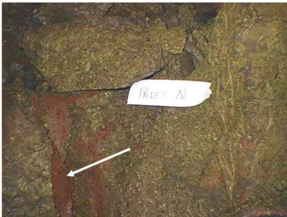
Figura 4. Grieta rellena con óxidos de Fe en la zona saprolítica. Sector E, profundidad 11 m. Foto cortesía de la A.E.I Geominera S.A.-San Felipe Mining Ltd.
