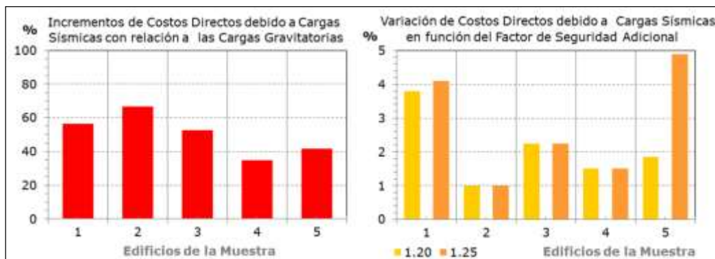
Figura 4. Incrementos de los costos directos de la cimentación debido a las cargas sísmicas y variación de los costos directos en función del factor de seguridad adicional seleccionado.
