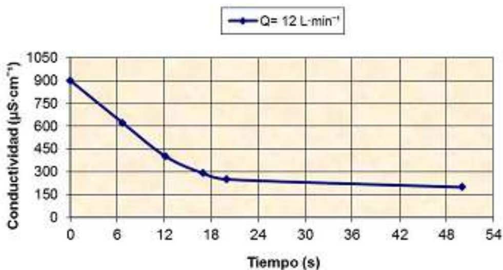
Figura 5. Comportamiento de la conductividad en función del tiempo de residencia en la zona de ingreso del reactor flujo pistón con deflectores entre los puntos 1 y 2 de muestreo para el máximo flujo estudiado.
