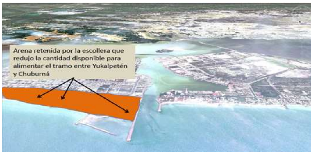
Figura 6. Efecto del puerto Yucalpetén en el proceso erosivo. Figura tomada de López-Gutiérrez (2011).
