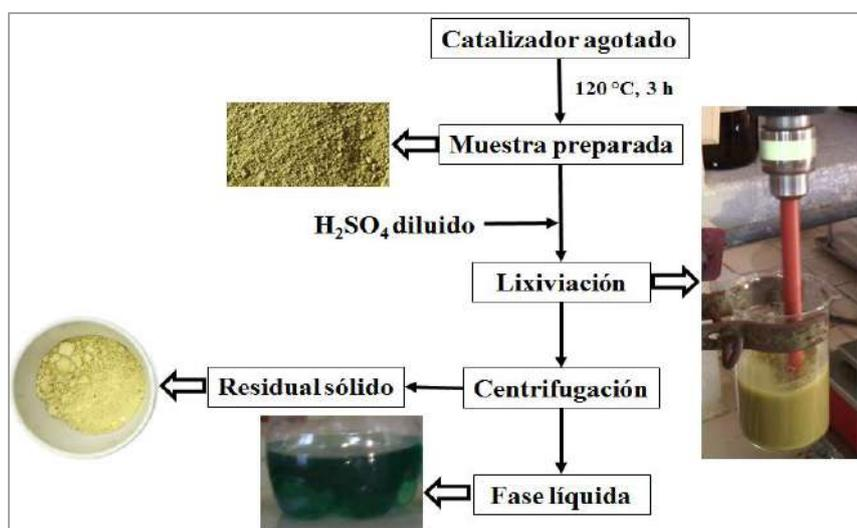
Figura 1. Esquema general del procesamiento.
