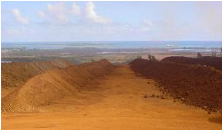
Figura 4. Pilas de mena laterítica expuestas a secado natural. **Fuente:** Retirado (2012).
