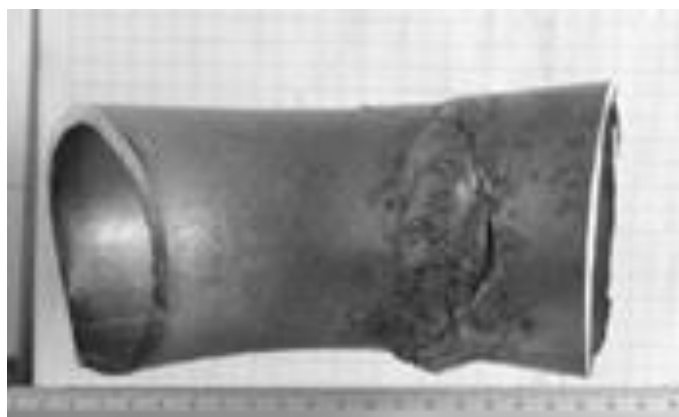
Figura 4. Componente fracturado fuera de la zona de trabajo.
