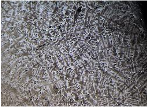
Figura 1. Microestructura del acero AISI 420 en estado de fundición (X 40).
