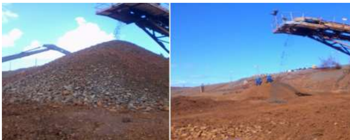
Figura 1. Depósito del rechazo serpentínico en la planta de preparación de pulpa de la empresa niquelera de tecnología HPAL.
