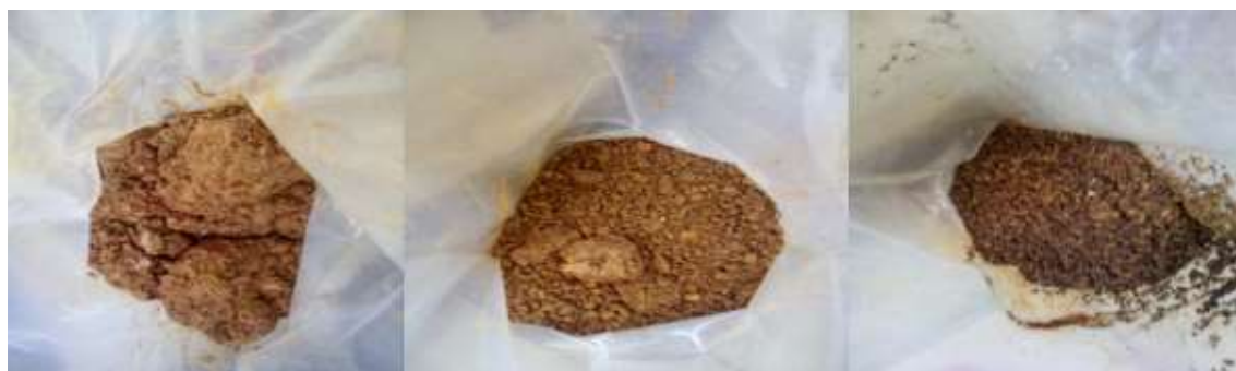
Figura 2. Muestras del rechazo serpentínico de la tecnología HPAL.
