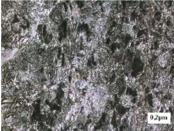
Figura 7. Microestructura de la zona de influencia térmica
