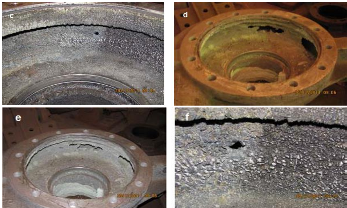
Figura 2. Efecto de la concentración de la pulpa en el cuerpo de la bomba.
