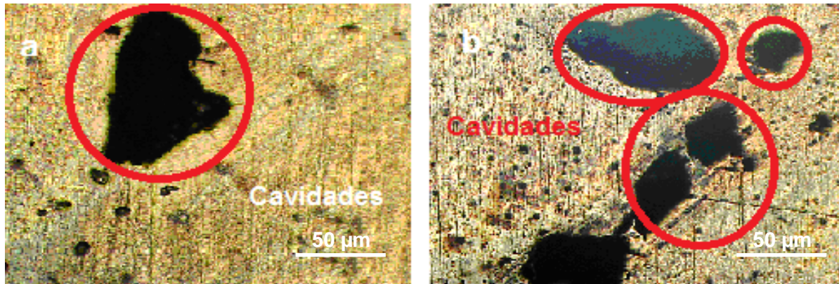
Figura 4. Cavidades en el interior de la voluta.
