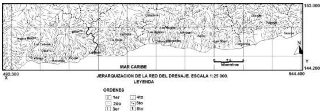
Figura 3. Jerarquización de la red del drenaje.
