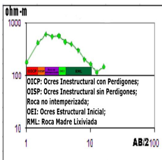
Figura 8. Curva de resistividad aparente pa de tipo "K" con litología asociada, yacimiento Yagrumaje Norte, bloque 0758, pozo 05.
